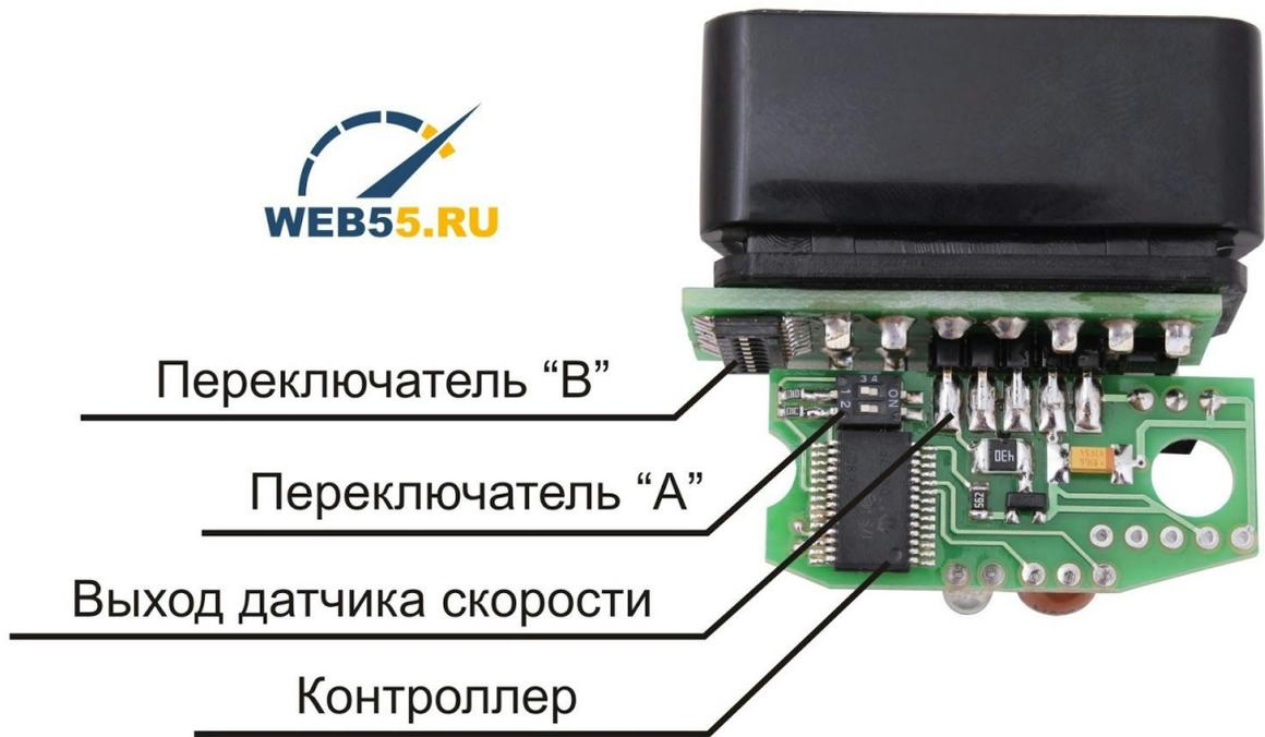
**Переключатель "А"** - предназначен для выбора, как будет работать устройство, с датчиком скорости или по CAN.
